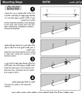
جهت حفاظت درجه IP چراغ، اتصال کابلهای چراغ در جانکشن باکس مناسب، الزامی است. In order to protect the IP rating of the light, it is necessary to connect the light cables in the appropriate junction box
