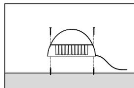
2 با استفاده از پیچ و رول پلاک موجود چراغ را در محل مناسب نصب کنید. install the luminaire on desired location by screw and dowels.
