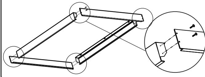
ابتدا چهار برآکت را بوسیله پیچ های مخصوص اتصال برآکت ها، به یکدیگر متصل نمایید.
