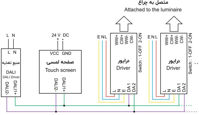
نکته: چهت روشن شدن صفحه لمسی (Touch screen) و لتاژ 24 V DC مطابق شکل به آن متصل گردد.
