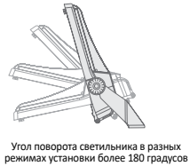
Угол поворота светильника в разных режимах установки более 180 градусов
